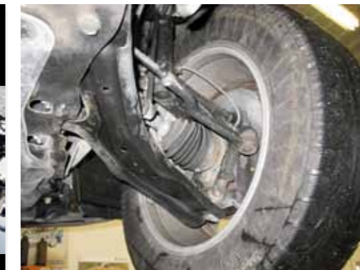
Spodní přední ramena jsou proti qashqaiům zesílená výztuhou. Problém zde byl zatím jen s vůlemi a hlučností horního uložení tlumičů, převážně u prvních ročníků.
