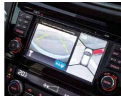
Panoramatický 360° kamerový systém AVM u lépe vybavených variant usnadňuje parkování i orientaci v terénu, kvalita obrazu ale nepatří k silným stránkám
