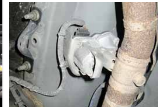
Servopohon výfukové klapy pomáhající recirkulaci výfukových plynů je tu na rozdíl od qashqai o něco lépe chráněn před poškozením terénními jízdami
